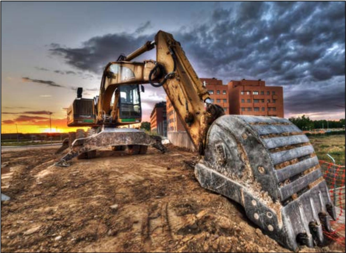
Se denomina pala excavadora a una máquina autopropulsada, sobre neumáticos o orugas, con una estructura capaz de girar al menos  $360^\circ$  (en un sentido y en otro y de forma ininterrumpida) que excava o carga, eleva, gira y descarga materiales por la acción de la cuchara, fijada a un conjunto formado por una pluma y un brazo o balancín, sin que la estructura portante o chasis se desplace.
