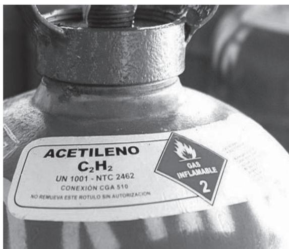
El acetileno es un alquino que se utiliza como fuente de iluminación y de calor. En la vida diaria el acetileno es conocido como gas utilizado en equipos de soldadura debido a las elevadas temperaturas (hasta 3000 °C) que alcanzan las mezclas de acetileno y oxígeno en su combustión.
